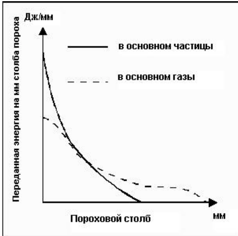
Рисунок 69: Передача энергии различными капсюльными компаундами.
