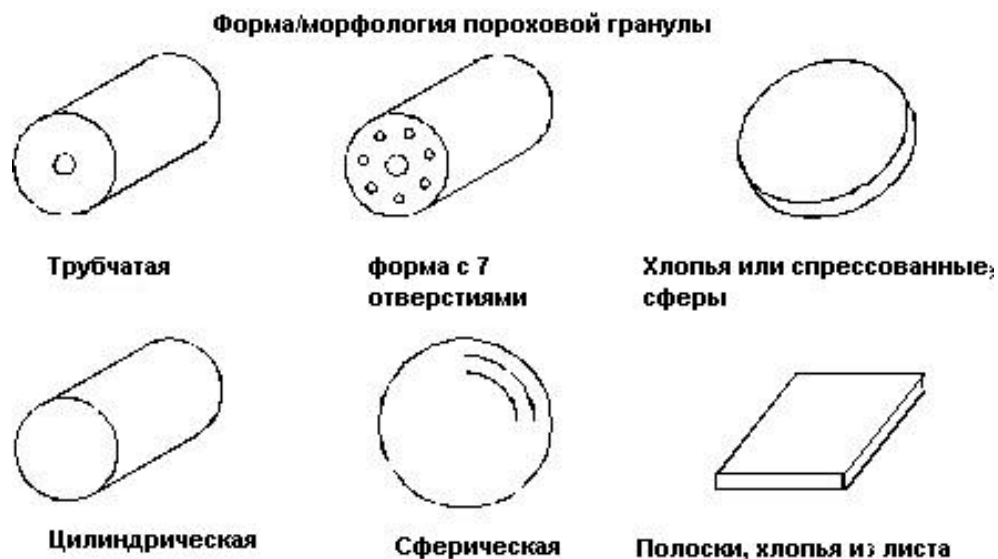
Рисунок 71: Примеры Бездымных Порохов, Формы Гранул.
