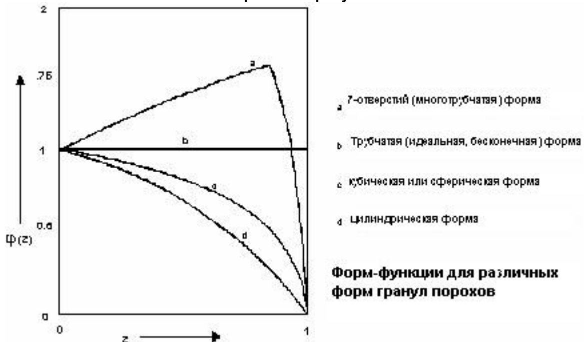
Рисунок 72: Виды форм-функций для геометрий порохов
