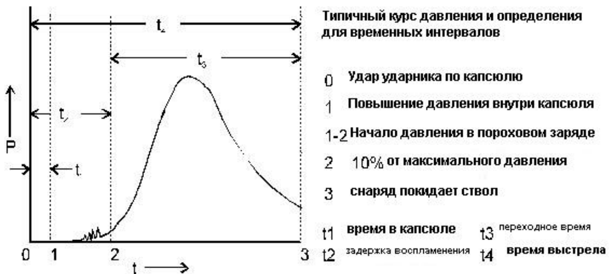
Рисунок 67: Типичная кривая давления внутри камеры сгорания (измеренного внутри патронника).
