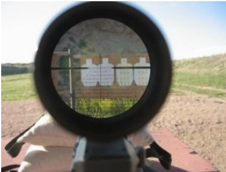
Вид через сетку Horus H25 при увеличении приблизительно 12х , мишени на дистанции 100 ярдов).
