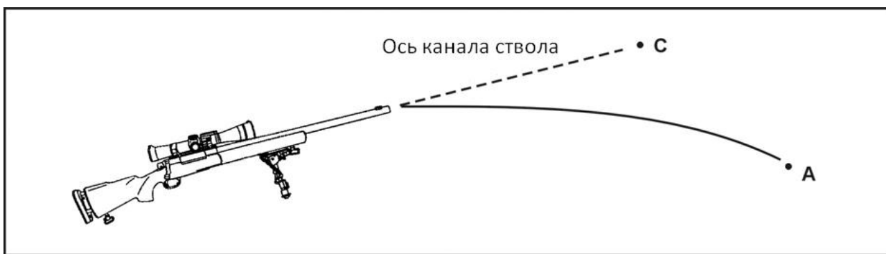
Рис. 3-25. Траектория пули, когда винтовка поднята на угол возвышения.
