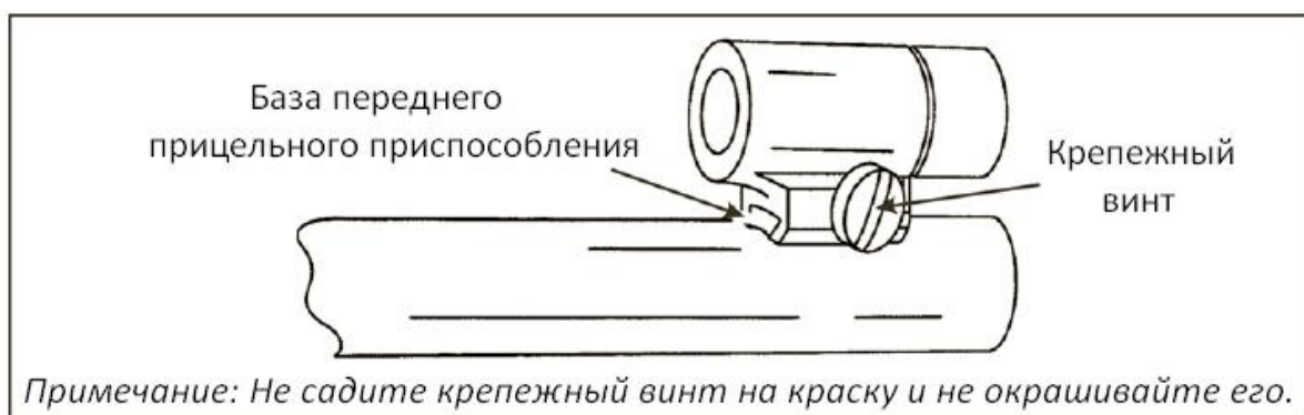
Рис. 2-7. Установка переднего прицельного приспособления.
