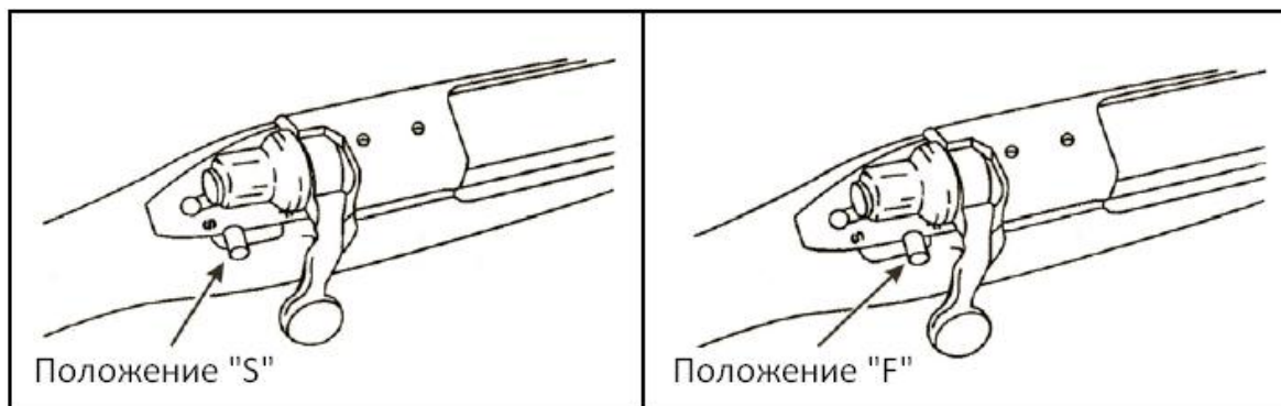
Рис. 2-2. Постановка и снятие винтовки М24 с предохранителя.
