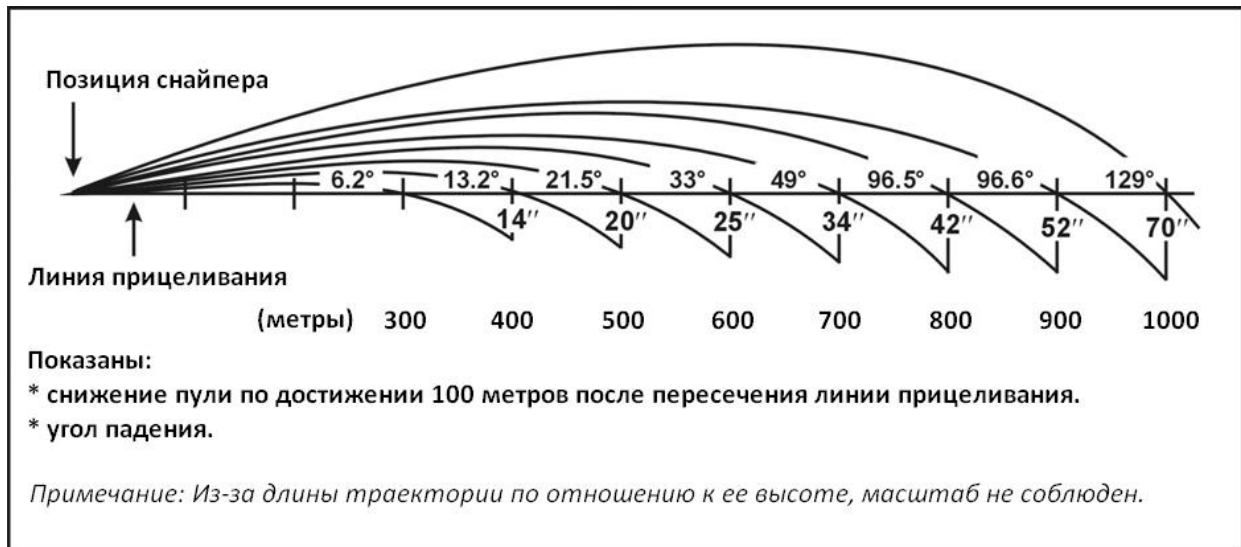
Рис. 3-26. Линия прицеливания снайпера с углами падения траектории на различных дальностях.
