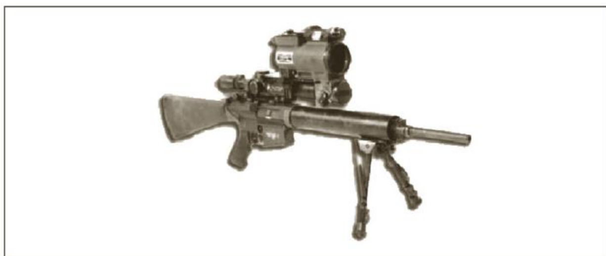
Рис. 2-17. Усилитель изображения NADS 750 с ИК осветителем/целеуказателем AN/PAQ-2, установленные на винтовке SR-25.
