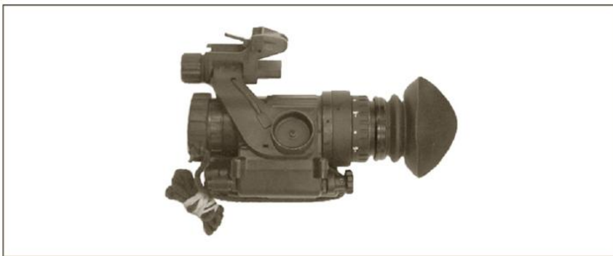
Рис. 2-25. Монокуляр AN/PVS-14 вместе с креплением к шлему.
