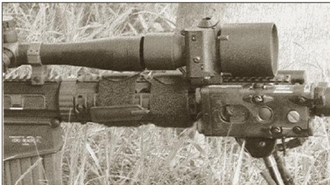
Рис. 2-19. Прицел-усилитель Модель 007 «Universal Clip-On» с AN/PAQ-2.
